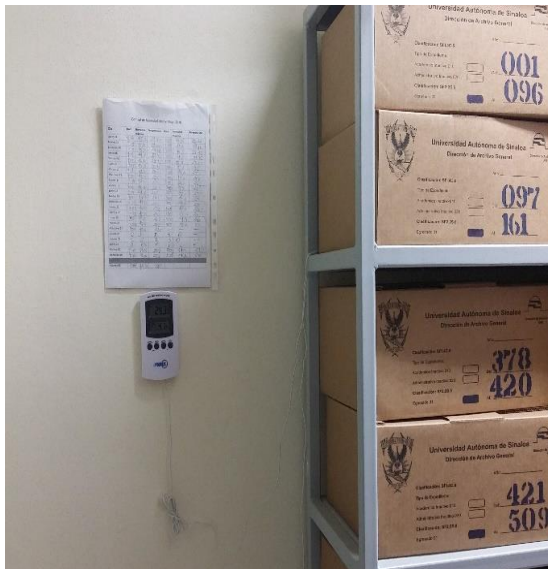
Figura 1: Termo-higrómetro colocado en pared
